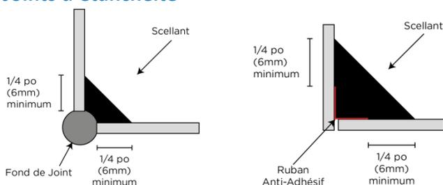
Lorsqu'il est impossible d'insérer un fond de joint conventionnel (ADSEAL BACKER ROD), il est recommandé d'utiliser un ruban anti adhésif.
