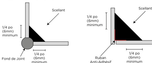
Lorsqu'il est impossible d'insérer un fond de joint conventionnel (ADSEAL BACKER ROD), il est recommandé d'utiliser un ruban anti-adhésif.
